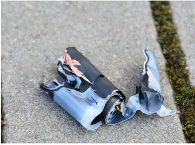
Lithium Akkus und Batterie- Speichersysteme werden nach besten Standards gebaut und haben eine hohe Qualität an Absicherungen. Leider kommt es in seltenen Fällen zu Beschädigungen oder chemischen Reaktionen, die eine größere Hitzeentwicklung oder sogar einen Brand zur Folge haben können.
